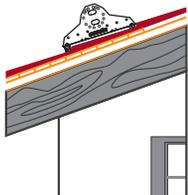
2. В случае комплекта ограждения со снегозадержателем установите в кронштейн трубы снегозадержателя и скрепите их между собой болтами М8х30, гайками и шайбами. В случае комплекта ограждения без снегозадержателя перейдите к пункту 3
